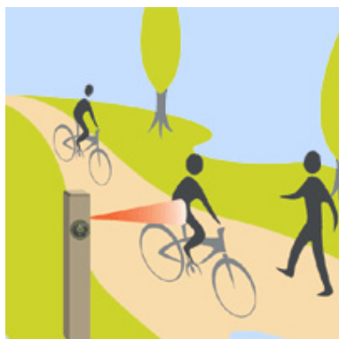
Obrázek 23: Pyroelektrický senzor PYRO Zdroj: www.scitace.cz
