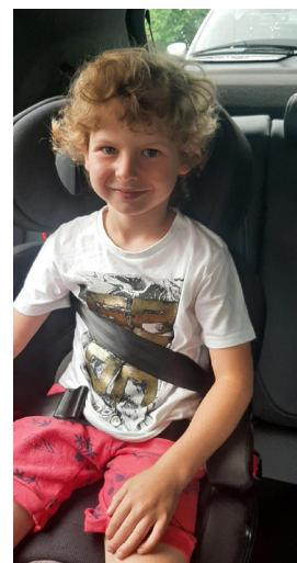
Pás je upevněn nesprávně pod paží
